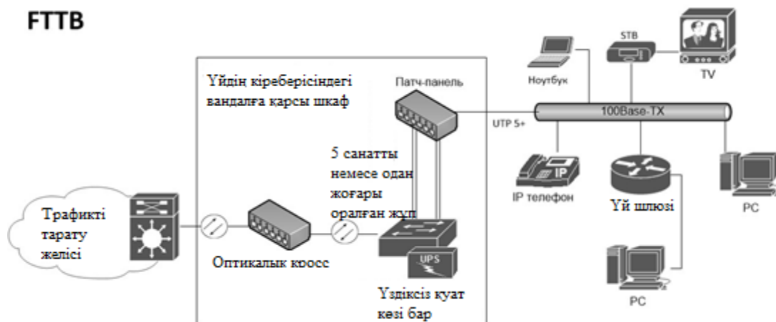
2.7 Сурет - FTTB технологиясын қолдана отырып, кеңжолақты абоненттік қатынау желісін ұйымдастырудың жалпыланған схемасы
